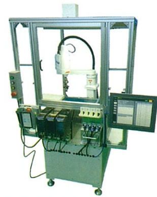
ピックアシストシステム ロボットで各種パーツをトレイに移動するシステム。アプリケーションにより、ロボット制御の知識がなくても簡単にピッキングパターンを作成・編集することができます。組み立てに必要なパーツを順番にトレイに並べることにより、作業効率アップ、組付けミス防止します。
