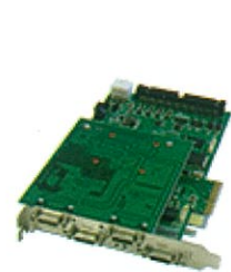
画像入力ボード MUCap-HD4eH カメラからの画像をPCに取り込むための画像入力ボード。1スロットで1.5GB/sの高速転送や、4カメラ同時接続が可能。カメラインターフェースは業界標準のCamera Linkを採用。 ※CoaXPress I/F対応ボードも取扱っています。
