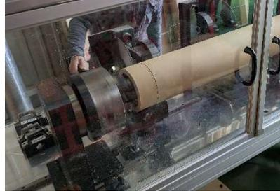
装置における紙管切断の様子
